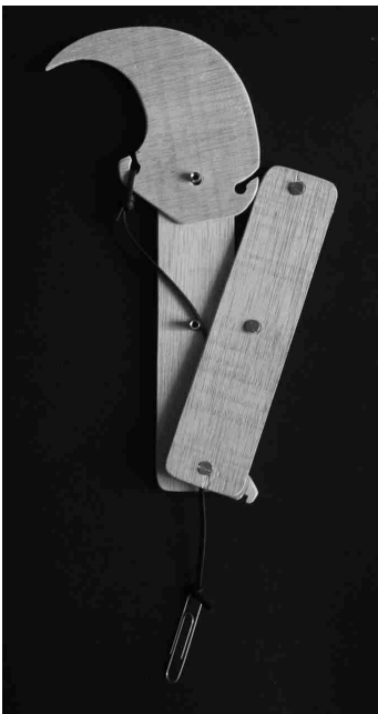
Pas 3.7. Col·locació del cordill, entre els separadors mètrics
